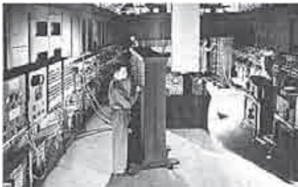
Figura 2: El ENIAC, primer ordenador electrónico digital. Incluía 19.000 tubos de vacío y ocupaba una sala de 100 m 2
