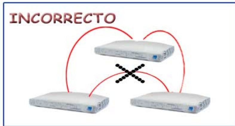
Figura 3. Conexi n incorrecta de Hubs.
