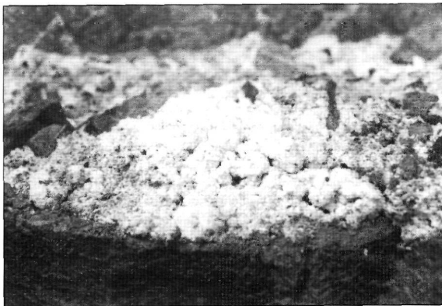
Fig. 26. Fotografia d'una acumulació de pickeringita i billinita com a resultat de la formació de sulfats
