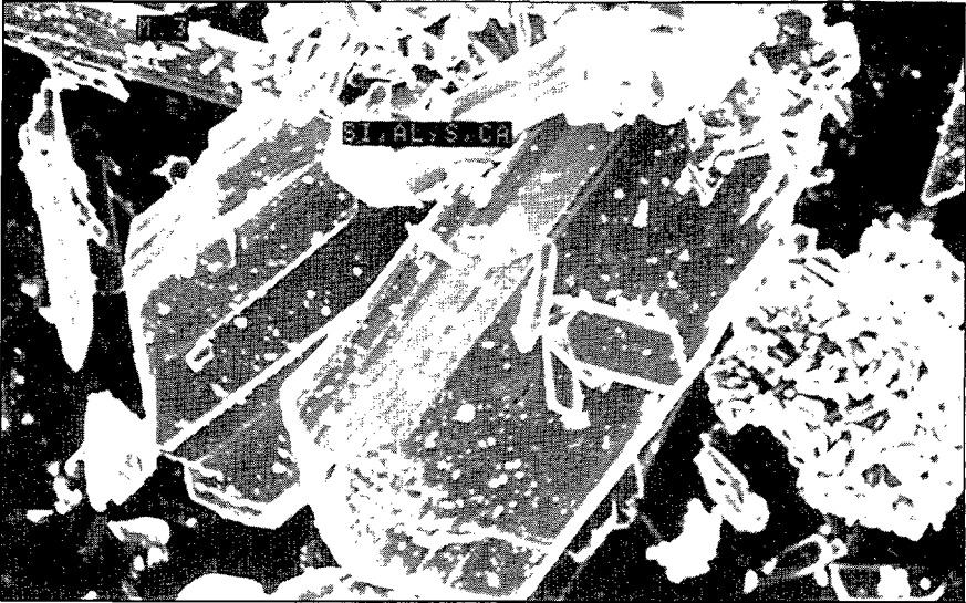
Fig. 18. Microfotografia de l' Scanning S-120 que ens indica la disposició, la morfologia i el creixement d'aquests cristalls de guix amb nòduls i agregats de goethita
