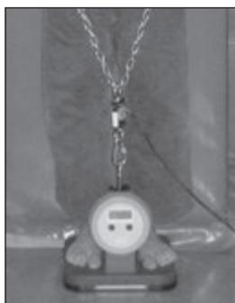
**Figura 3 - Célula de carga unida ao dinamômetro lombar Takei T.K.K. 5102 para a realização do squat isométrico 160°**
