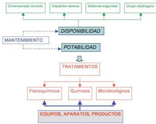
Figura 1. Requisitos de la instalación de agua
