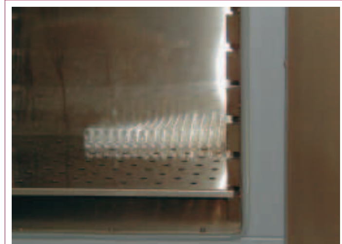
Foto 3 y 4. Tubos Colectores, una vez atemperados deben ser transportados en gradillas
