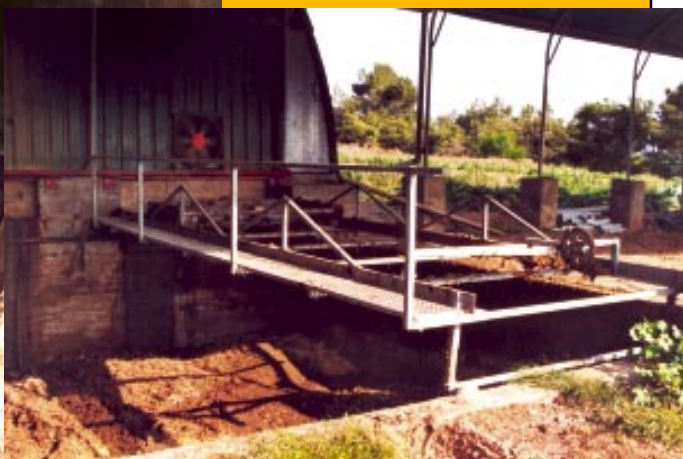
La producción animal respetuosa con el medio ambiente hace necesaria tener amplios estercoleros para poder acumular las deyecciones durante al menos 6 meses. Mediante esta plataforma la pala se traslada entre pasillos para realizar la limpieza.
