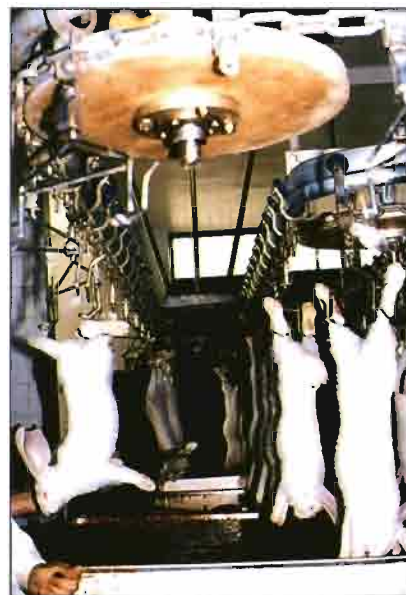
Detalle del canal de matanza y desangrado de los conejos. La instalación tiene una capacidad para 1.200 gazapos hora.
