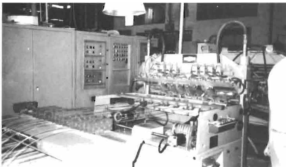
Enfoque parcial de una de las líneas de soldadura automática para fabricar parrillas de alambre
