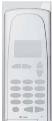
Fig. 5. Imagen de la carátula de celular cuyo proceso de inyección se simuló por medio del MoldFlow.
