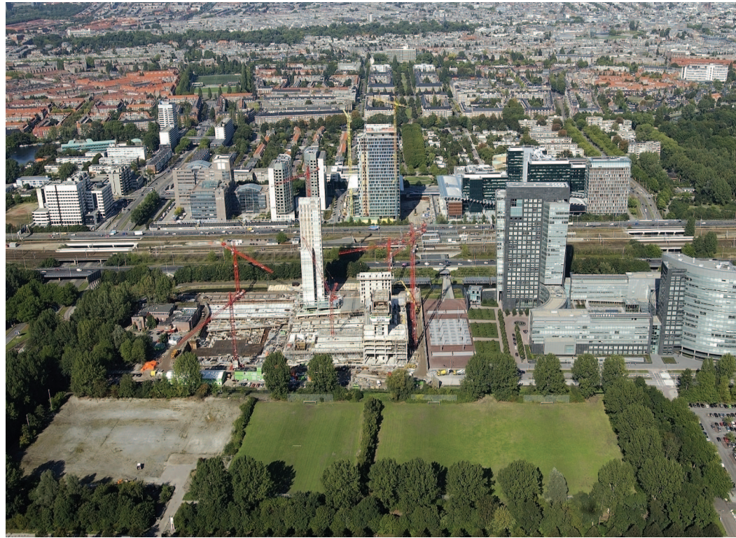
Figura 10: Comparación de la situación actual y futura propuesta en el sector Zuidas. La necesidad de ampliar la infraestructura implicaría prácticamente la duplicación de la sección de la vía de circunvalación. En la última configuración de la infraestructura en túneles (en fase de estudio) el metro se sitúa en dos niveles superpuestos, al igual que la autopista de circunvalación, para permitir la existencia de aparcamientos subterráneos.
