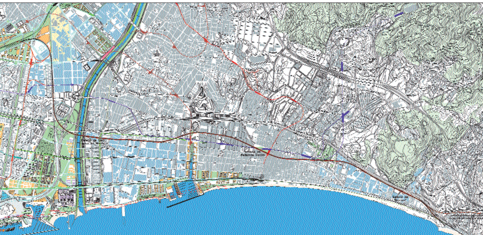
Figura 2: Esquema de las propuestas del Plan Director de Infraestructuras 2001-2010, que incluye la alternativa al ferrocarril de la costa y las conexiones tren-metro.
