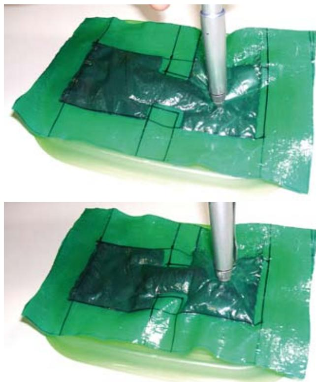
Figura 2. Fluido magneto-reológico. Primero se muestra el fluido sin aplicar campo magnético (poco impedimento a la penetración), después con la aplicación de un campo (ofrece mayor impedimento a la penetración, es decir mayor dureza).
