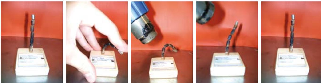
Figura 1. Ejemplo de una aleación con memoria de forma. Primero se deforma el material en frío, posteriormente se aplica calor y el material recupera su forma inicial.
