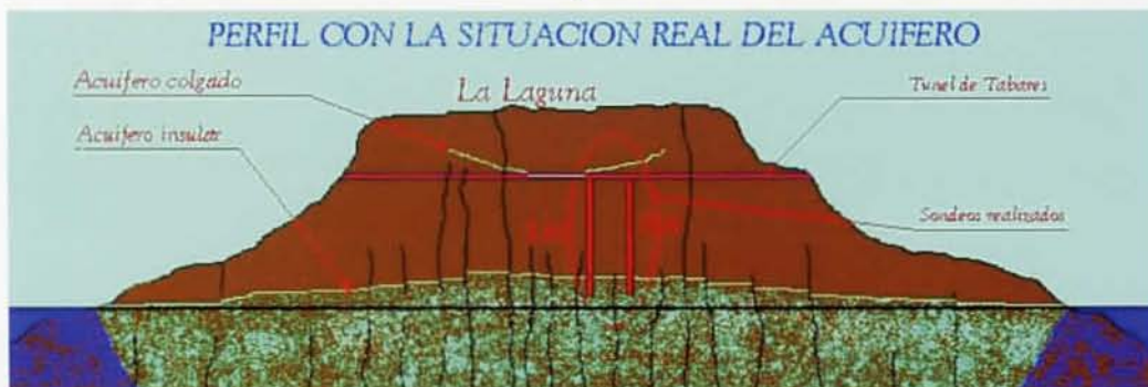
Perfil hidrogeológico de Tenerife entre Bajamar y Santa Cruz, donde se indican los sondeos perforados dentro del túnel de Tabares, que suministra agua a Santa Cruz de Tenerife.
