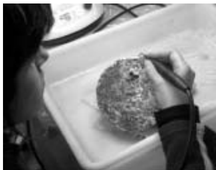
Limpieza de objetos de plomo mediante abrasión con microesferas de vidrio -microabrasímetro- (arriba) y ultrasonidos (abajo)
