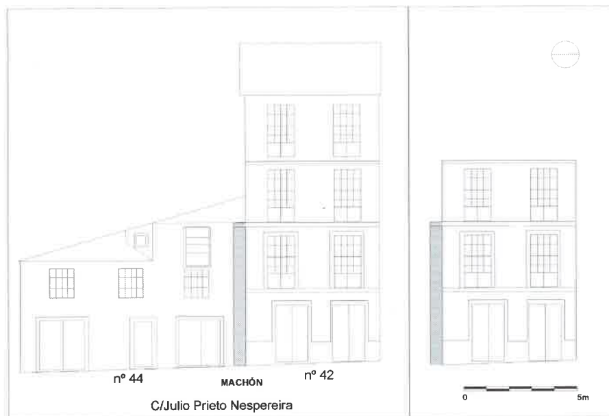
Plano 5: Alzado de los edificios de C/Julio Prieto Nespereira nº 42 y nº 44 (esquina C/Lugo nº 13) antes y después de las demoliciones realizadas, con indicación del machón donde se localizan los restos de Porta da Aira.
