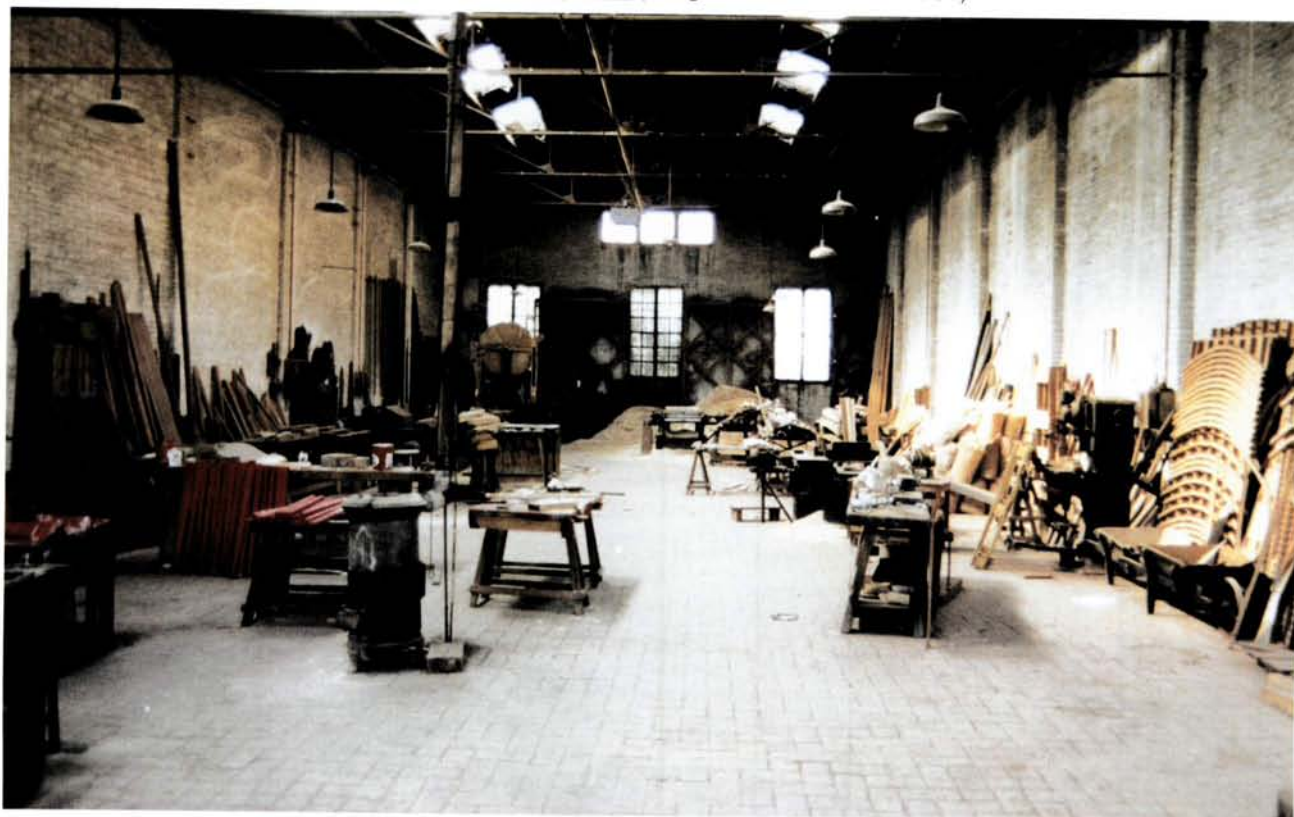
Nau número 17. Secció de Fusteria, on es treballaven les peces de fusta, com les barres de tir, les bieles, les plataformes, els camatimons... Any 1995. (Fotografia: Oriol Saula. AFMCUT)
