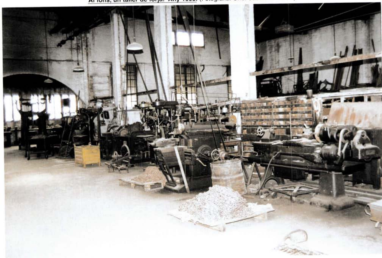
Nau número 12. Secció de Lligadores. Observem les màquines per mecanitzar les peces de les lligadores. Al fons, un taller de forja. Any 1995. (Fotografia: Oriol Saula. AFMCUT)
