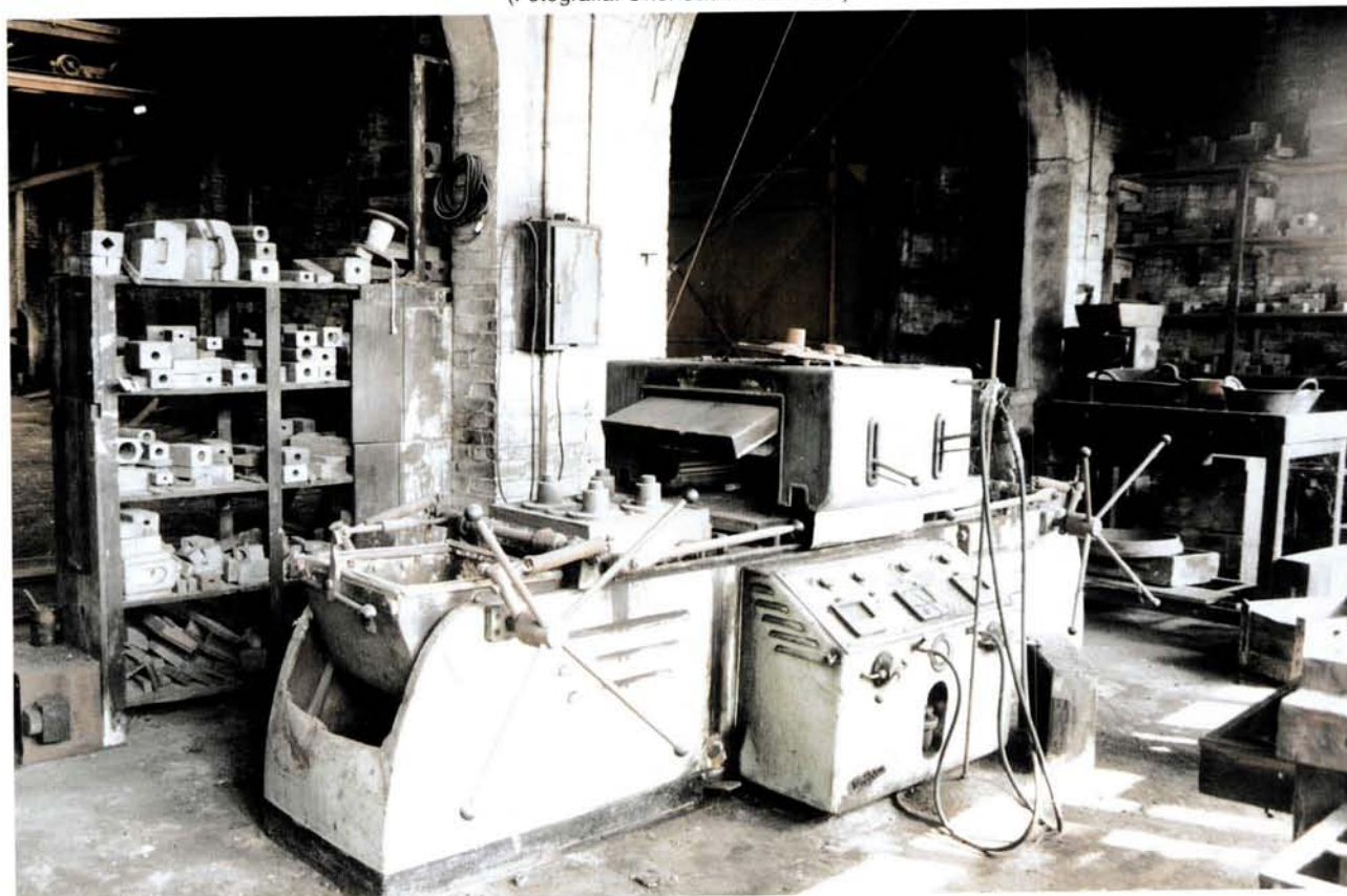
Nau número 1. Màquina de fer motlles amb resines sintètiques. Any 1995. (Fotografia: Oriol Saula. AFMCUT)
