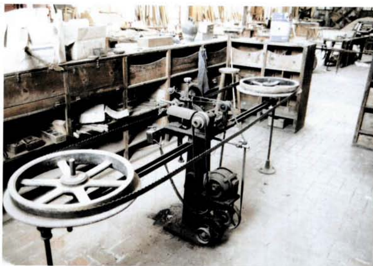
Nau número 17. Zona de l'encarregat de la fusteria. En primer terme, la màquina afiladora de les serres de cinta.
