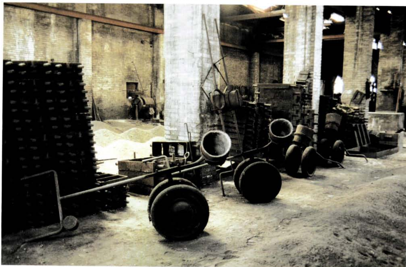
Nau número 2. Carretons individuals amb el gresol que transportava el ferro fos. Any 1995. (Fotografia: Oriol Saula. AFMCUT)
