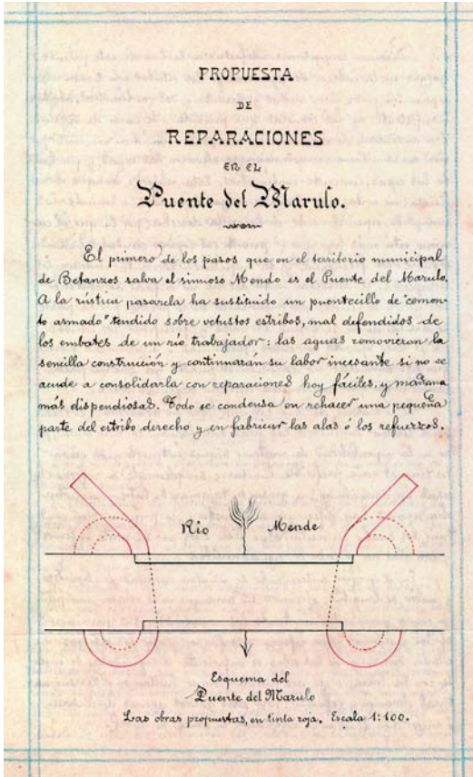
Proposta de reparación da ponte do Marulo. 1932. AMB, c-512.
