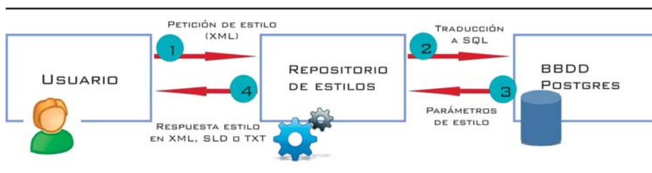
Figura 4. Ejemplo de comunicación entre el usuario, la base de datos Postgres y el Catálogo-Repositorio
