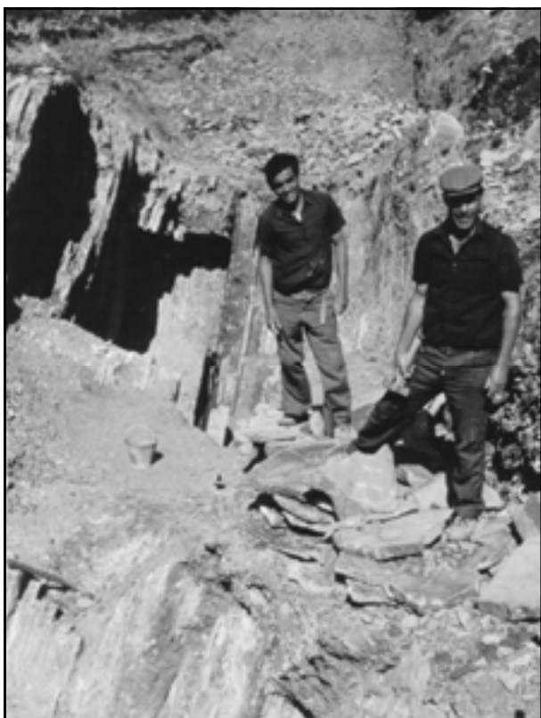
Imagen 2. Canteros extrayendo de la cantera de Mojícar la piedra de Tarifa, utilizando materiales como el escafilador, la machota y el cincel.
