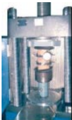
Figura 2. Probeta a compresión con deformímetro mecánico instalado.
