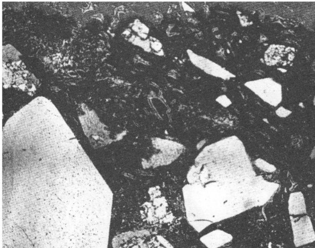
Figura 10.- Fotomicrografía de la toba T-1, que contiene abundantes fenocristales. En la matriz de la parte sin piroconsolidar, es común observar numerosas esquirlas de vidrio y fragmentos de pómez sin colapsar. Los fenocristales más abundantes son de cuarzo (c) y sanidino (san). Luz plana polarizada; amplitud del campo visual 3.6 x 2.4 mm.
