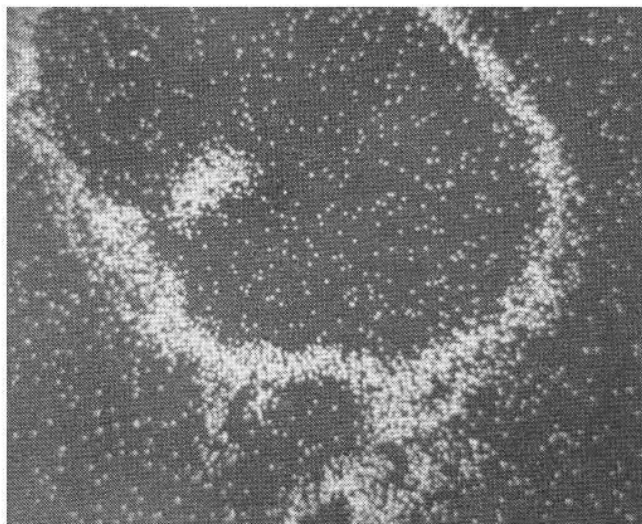
Figura 15.- Aguilarrita (análisis 22), rodeado por un anillo de polibasita. Imagen correspondiente a la Figura 11. Bajo rayos roentgen Sb L\alpha_1 . Largo de la imagen, 200\mu\text{m} .
