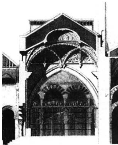
Lamina 3.- Detalle de la sección de la Capilla de Villaviciosa y de la planta de la nave gótica de catedral de Córdoba, dibujada por Ricardo Arredondo y publicada en la obra de Rodrigo Amador de los Ríos: Inscripciones árabes en Córdoba (1879)
