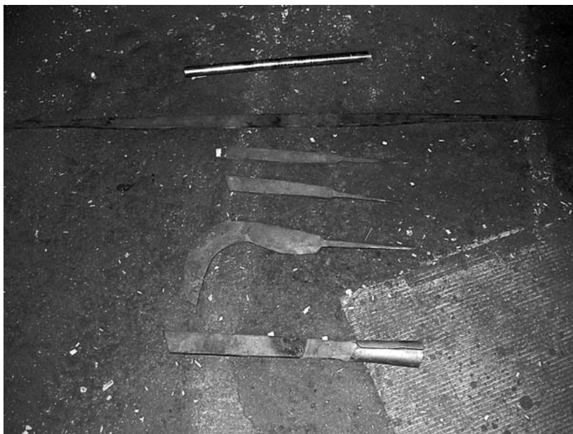
Detalle dos pasos de elaboración dunha fouce ou fouciño da forxa de Xosé Piñeiro de Vilaboa, Allariz-Ourense.
