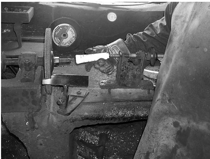
Preparación do mango das fources na forxa de Xosé Piñeiro de Vilaboa, Allariz-Ourense.
