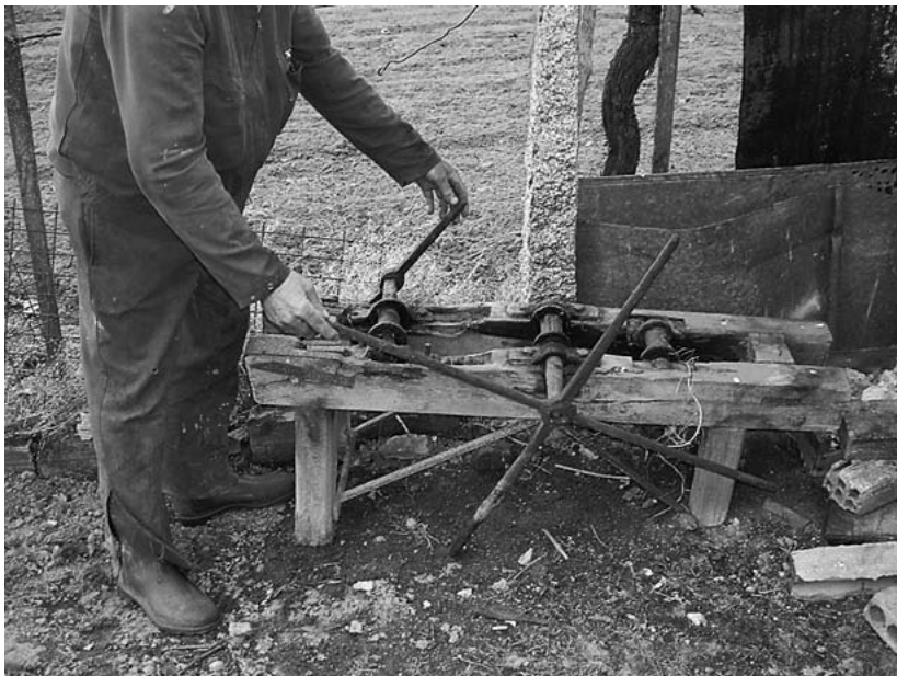
Banco de curvar as ferras da forxa de José Luis de Sta. Cruz da Rabeda, S. Cibrao das Viñas-Ourense.
