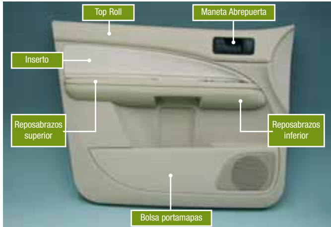
Figura 1. Elementos de diseño del panel del Ford Focus C-MAX considerados en el experimento.
