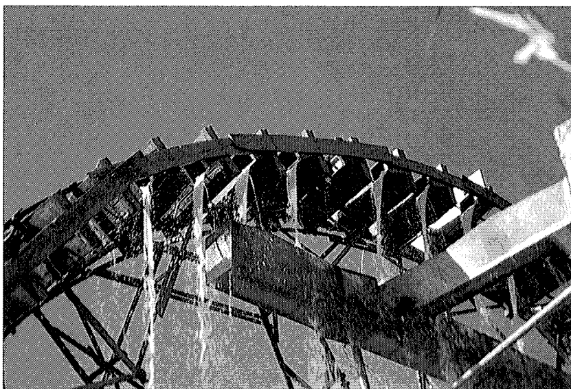
Lám. 4. Noria de Jauja en funcionamiento; en la fotografía puede apreciarse cómo se produce el vertido del agua desde los cangilones al añaquil.
