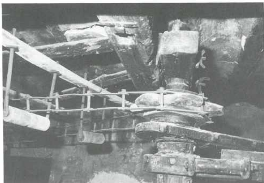
Foto núm. 28.—Detalle de la parte superior del árbol, donde se aprecia la «rueda catalina» y el rudimentario embrague para conectar el mecanismo.
