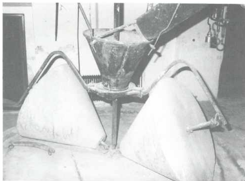
Foto núm. 4. —Molino con 2 rulos y tolva de chapa en el centro.
