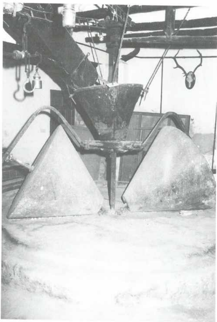
Foto núm. 23.—Empiedro con 2 rulos del Molino del Portichuelo. Jaén.
