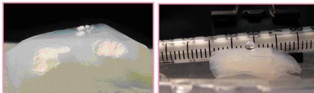
**Figura 4A y 4B.-** Gota de agua sobre un aerogel no fluorado y sobre el mismo aerogel fluorado
