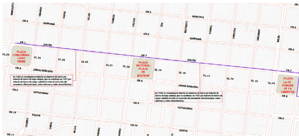
Pie de imagen: Trazado del acueducto de 1927 entre la Plaza La Fe y la Plaza Concordia en tubería de hierro. Mapa elaborado a partir de base cartográfica actual. Autor: Jorge Enrique Osorio Velásquez, digitalizó Juan Manuel Tapasco Velásquez. Fuente: Investigación Historia Urbana de Pereira: 1867 – 2000.
