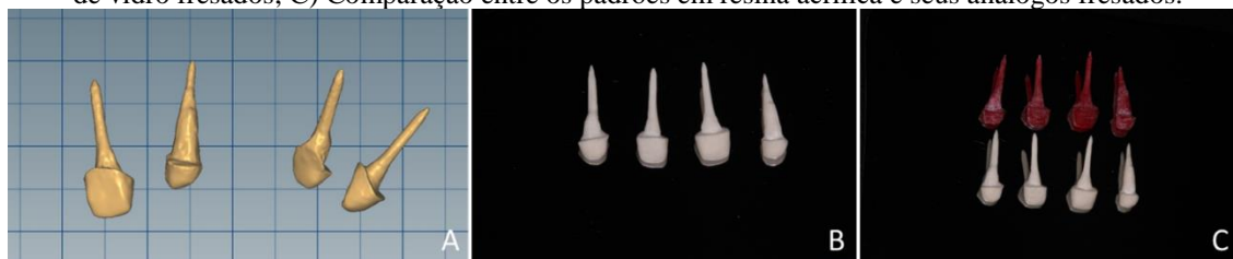
Figura 4: Pinos de fibra de vidro fresados. A) Padrões em resina acrílica digitalizados; B) Pinos de fibra de vidro fresados; C) Comparação entre os padrões em resina acrílica e seus análogos fresados.
