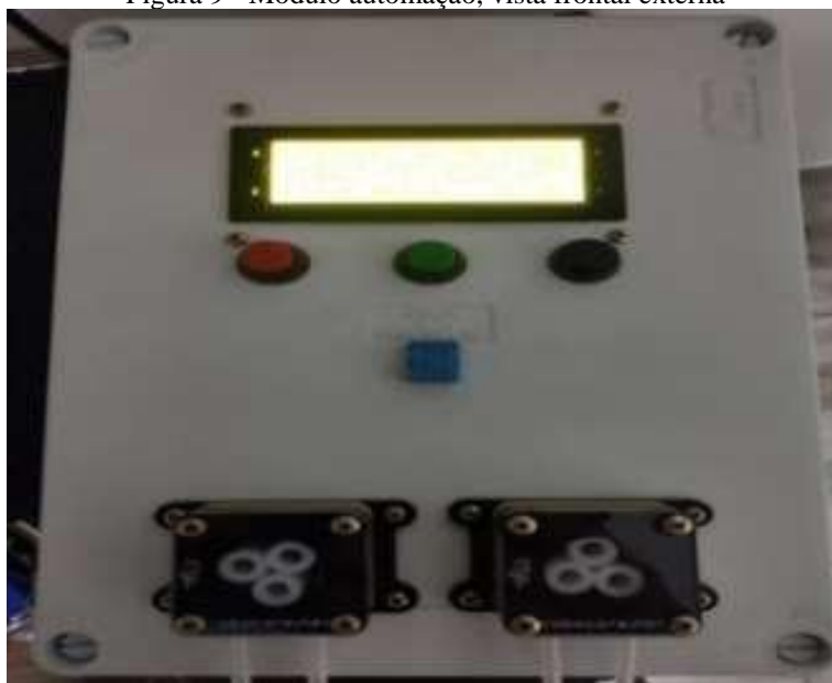
Figura 9 - Módulo automação, vista frontal externa
