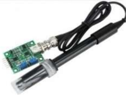
Figura 7 - Sensor de pH e sua interface de comunicação com Arduino.
