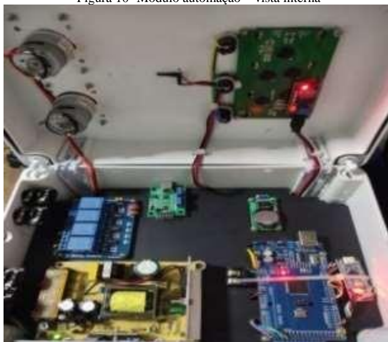
Figura 10- Módulo automação – vista interna
