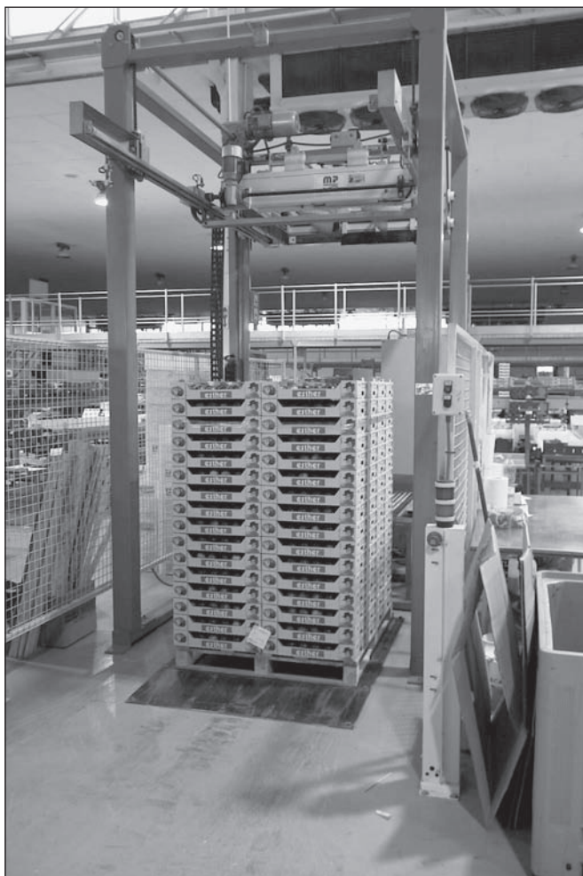
Foro 11. La paletización facilita el almacenaje y el transporte de los productos hortofrutícolas.
