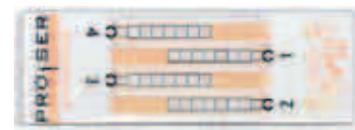
**Figura 2.** Imagen de una cámara de recuento ISAS® D4C, donde se aprecia su diseño y los siete recuadros donde se recomienda hacer los recuentos, con el fin de estandarizar el muestreo.
