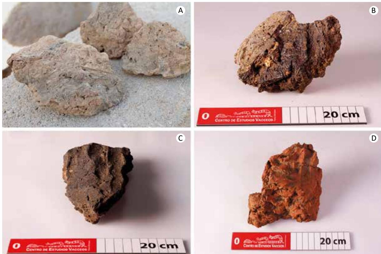
Fig. 9. A. Adobes sin termoalteración. B. Restos de capas de revoco de barro con distinto nivel de vitrificación. C. Revoco de barro con acanaladuras dejadas por los dedos. D. Masa de barro con surcos digitales.
