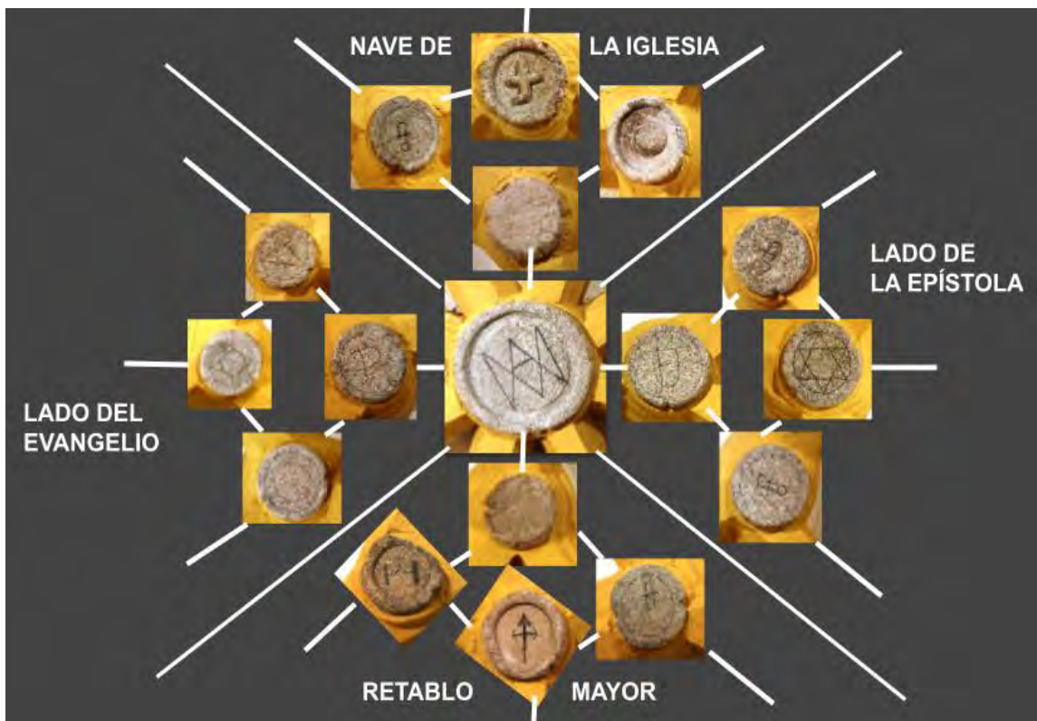
Figura 12. Distribución de las claves y de los nervios de la bóveda desde la entrada.
