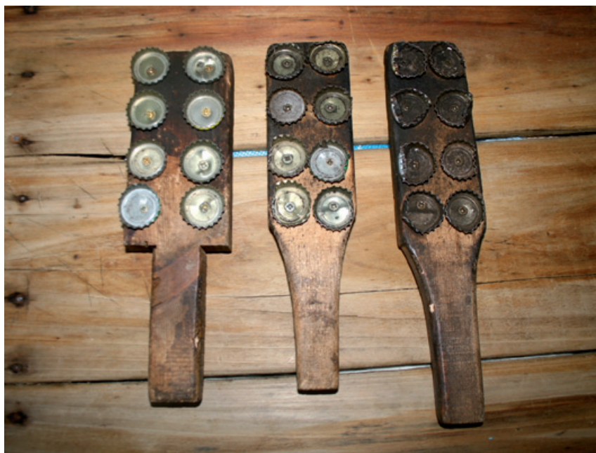
▲ Raspadores elaborados con chapas de botellas, clavadas sobre tablas de madera con un mango.
