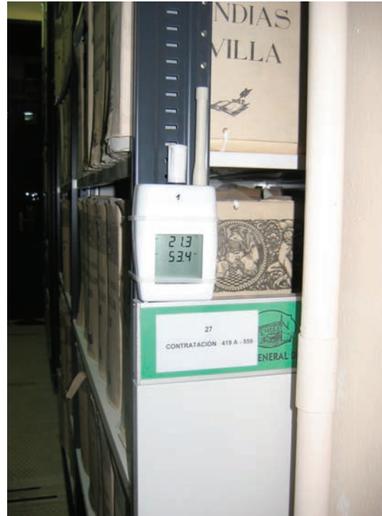
Lám. nº2 Sistema de monitorización de la HR y T mediante la colocación de data loggers
