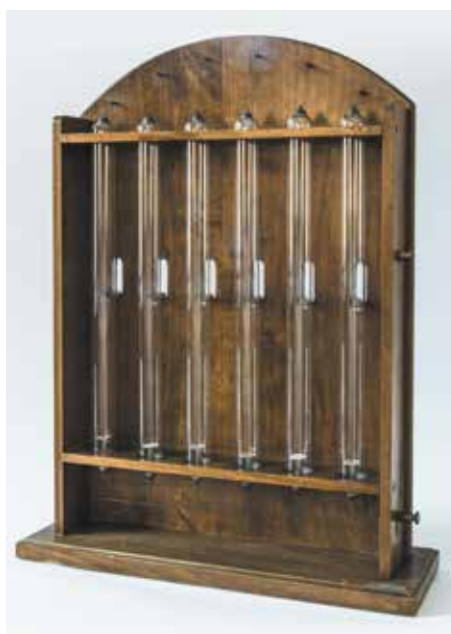
126. Tubos para descarga de gases enrarecidos (2º tercio del S.XX).
