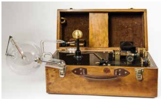
∧ 129. Aparato portátil de rayos X Sánchez . Patentado el 23 de septiembre de 1911. Construido por Laboratorio Eléctrico Sánchez. Piedrabuena, España. Madera, cobre, metal, ebonita. Medidas de la maleta: 22,5 x 44 x 22 cm. Instituto Histórico Bachiller Sabuco, Albacete.
