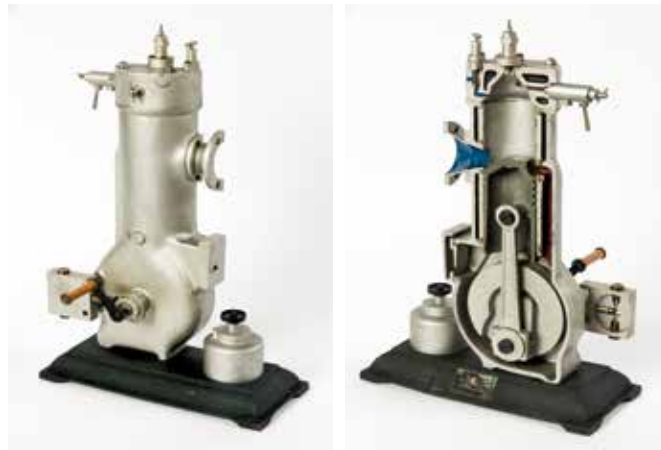
105. Prototipo motor de dos tiempos (primer tercio del S.XX). Distribuidor: T. Villanueva. Casa Torrecilla. Barquillo 43, Madrid. Metal, 38 x 24,5 x 11 cm. Instituto Histórico Bachiller Sabuco, Albacete.
