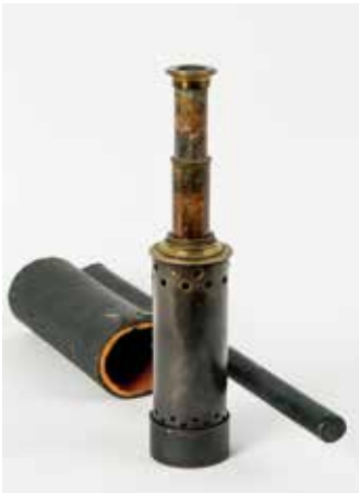
100. Hipsómetro de Regnault (con funda). (ca. 1877). Metal, 29 x 5,5 cm. Instituto Histórico Bachiller Sabuco, Albacete.
