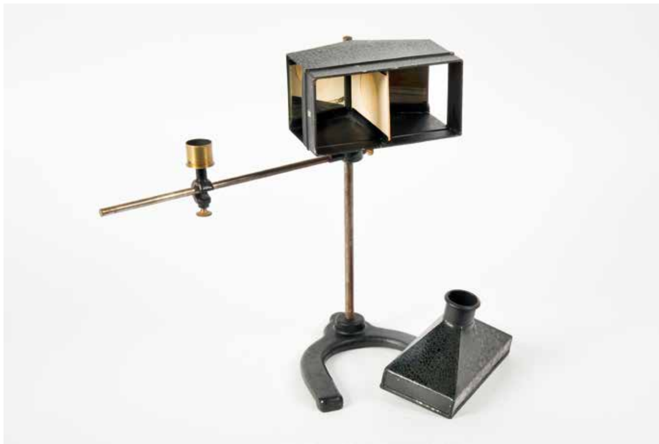
Fig. 10. Fotómetro de Bunsen. Fotografía: Francisco Cebrián García. Departamento de Física y Química.
