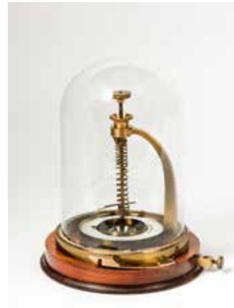
101. Termómetro de Breguet (ca. 1881). Madera, vidrio, latón, plata, platino y oro, 20 x 16,5 cm. Instituto Histórico Bachiller Sabuco, Albacete.
