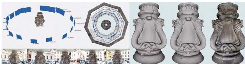
**Figura 15.** A sinistra: posizione dei fotogrammi per la foto modellazione digitale in vista prospettica e dall'alto con una sequenza di immagini del balaustro. A destra, tre modelli a confronto: il modello mesh ottenuto con laser scanner, il modello mesh ottenuto con processo di foto modellazione, il modello mesh ottenuto con processo di foto modellazione realizzato con mappatura fotografica.
