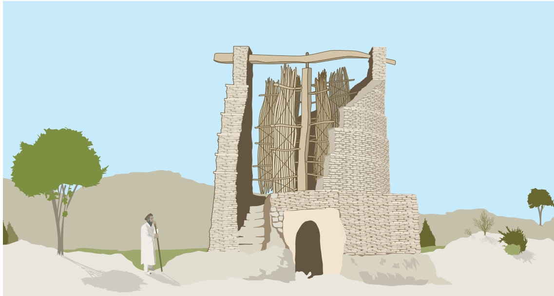
Molino de viento de eje vertical para moler grano. Afganistán, año 945.
