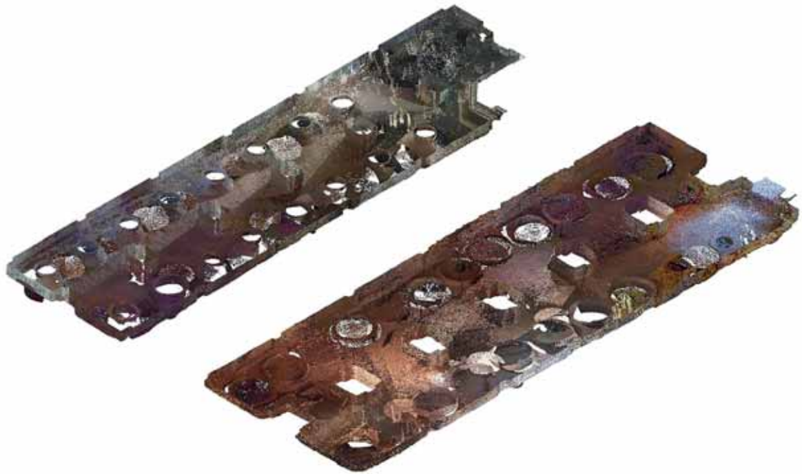
NUBE DE PUNTOS REALIZADA POR EL AUTOR CON EL LEVANTAMIENTO CON LASERMETRÍA DE ALTA PRECISIÓN DEL SUBSTRATO ARQUEOLÓGICO DE LOS SÓTANOS. (FUENTE: AUTOR)
