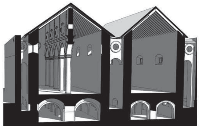
SECCIÓN TRANSVERSAL EXPLICATIVA DE LA CONFIGURACIÓN ARQUITECTÓNICA DE LAS NAVES. (DIBUJO DEL AUTOR)
