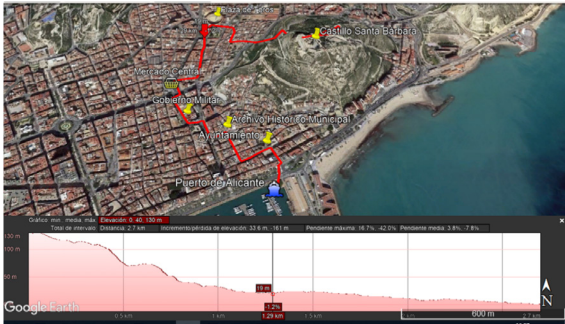
Figura 9. Construcción de un itinerario y perfil topográfico a partir de la herramienta “Ruta”.
