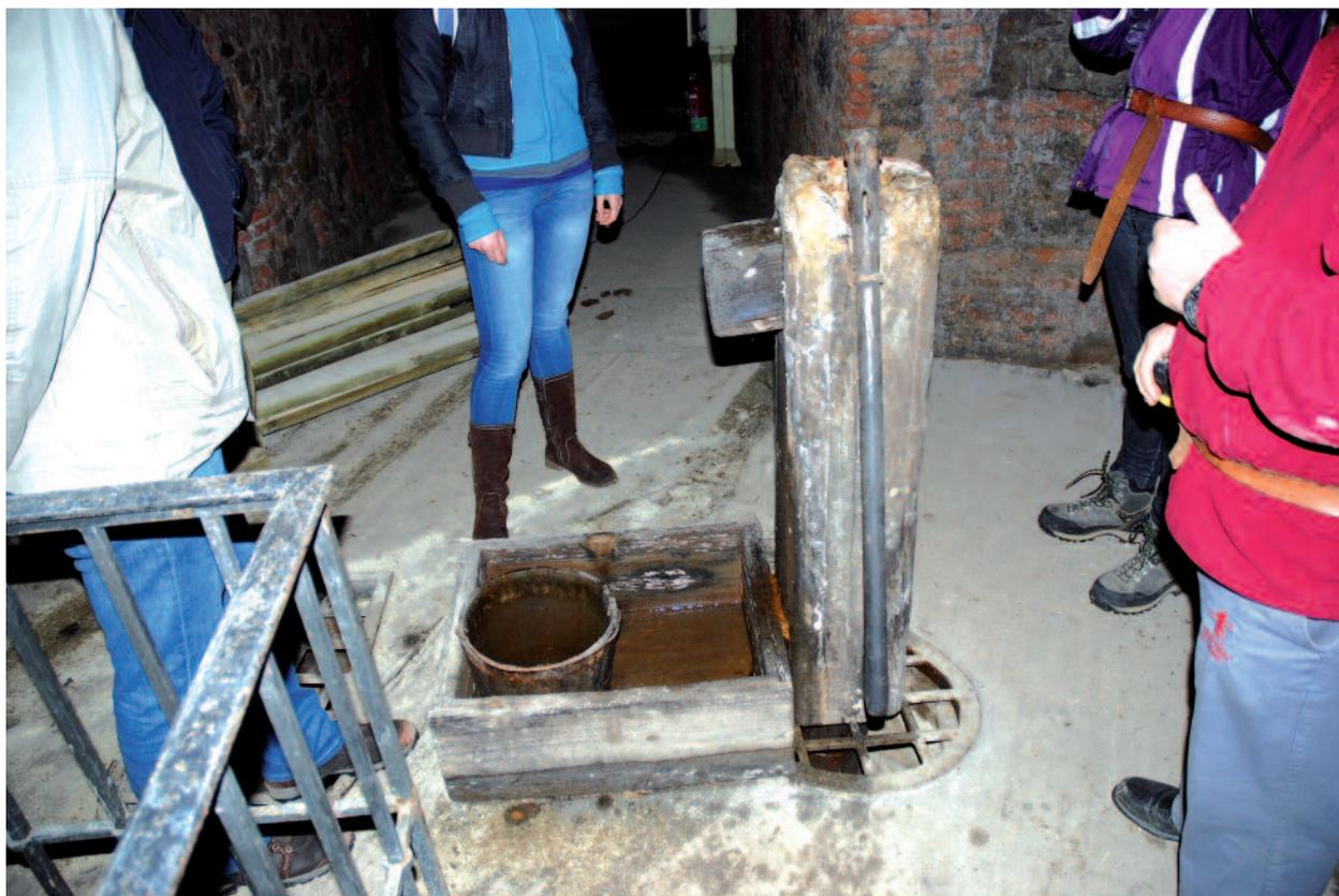
Figura 5. Bomba aspirante-impelente de madera reconstruida en minas de Almadén.
