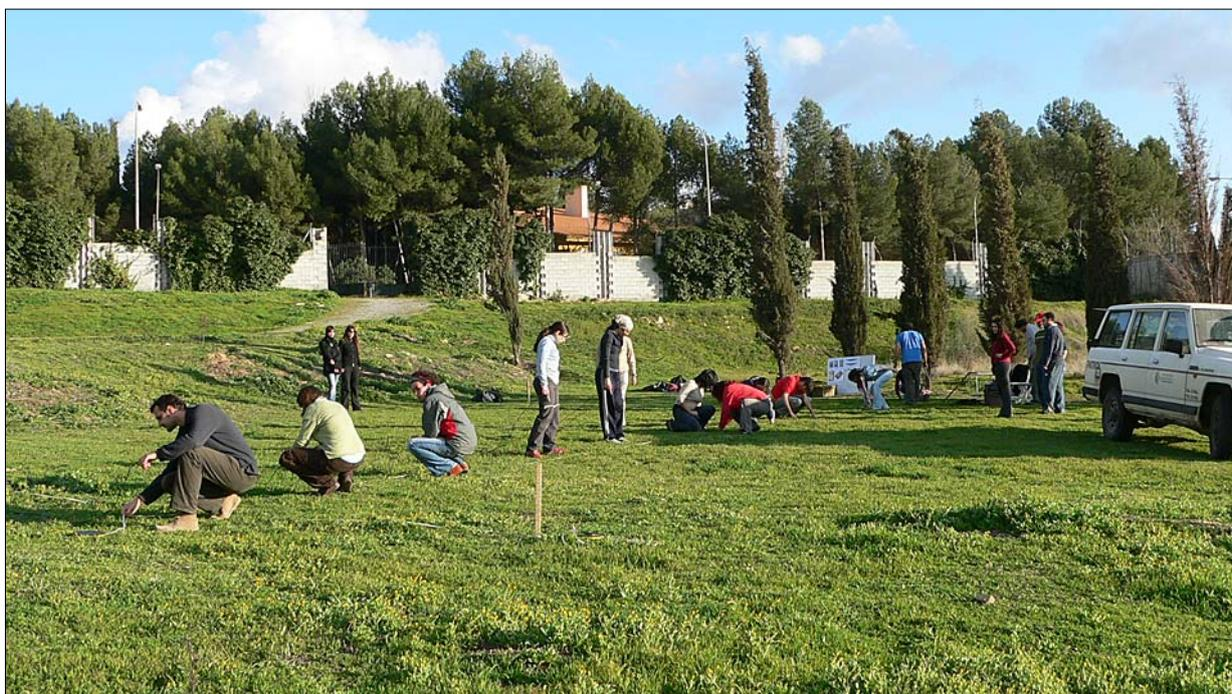
*Fig. 7. Montaje del perfil sísmico PS-2 (coincidente con el eléctrico ERT-2). La separación entre geófonos se estableció en 1 m y se usó para ello una cinta métrica.*
