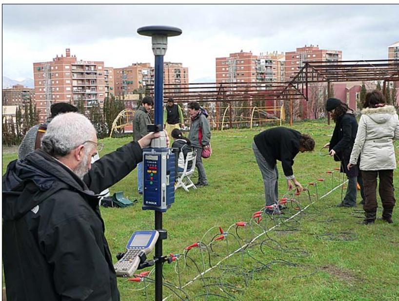
Fig. 5. Montaje de un perfil ERT. La separación entre electrodos se estableció en 0.5 m y se usó para ello una cinta métrica. En la imagen también se observa la base móvil del GPS de bifrecuencia utilizado para referir todos los datos geofísicos a un sistema de coordenadas preciso y reproducible.
