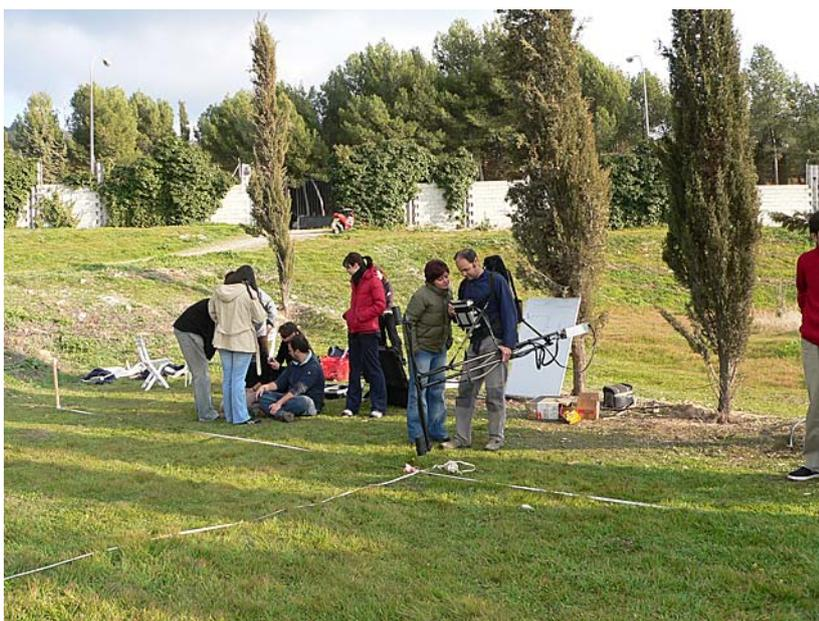
Fig. 3. Magnetómetro de vapor de potasio. Los dos sensores verticales están separados 1 m. En la foto se va a realizar un perfil que se materializa siguiendo un hilo que une dos cintas métricas que están colocadas en los bordes del rectángulo estudiado. En este caso se tomaron 10 lecturas por segundo.
