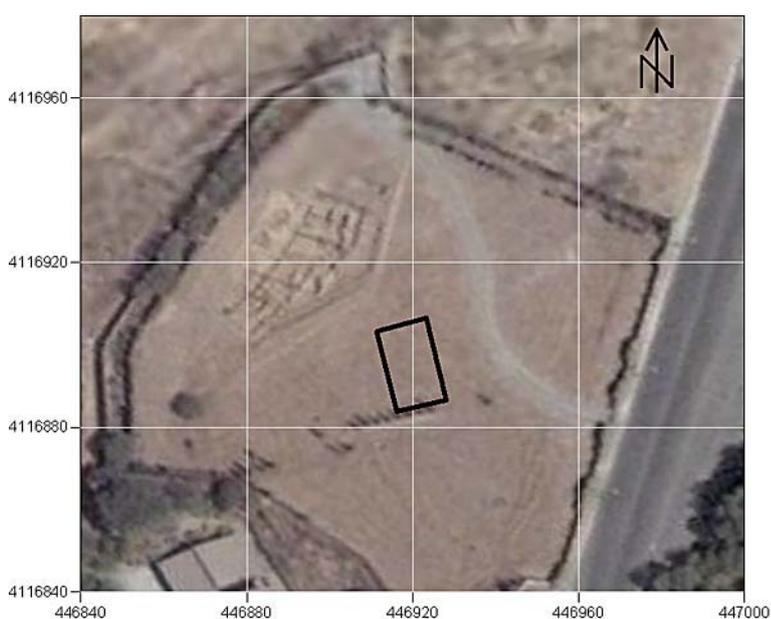
*Fig. 2 a y b. Yacimiento de los Hornos Romanos de la Cartuja (Granada). El rectángulo explorado con todos los métodos geofísicos mide 20 m x 12 m y se sitúa hacia el SE de la excavación. Las coordenadas están en UTM (ED-50). b) El tamaño, la distribución y las características físicas de las estructuras excavadas suponen un excelente banco de pruebas para aplicar los distintos métodos geofísicos y analizar sus respuestas.*
