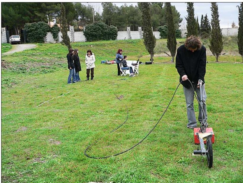
*Fig. 9. Obtención de datos rádar 3D. La antena tiene acoplada una rueda marcadora que fija con precisión la distancia de cada traza. En la parte lejana de la imagen puede verse la consola de recepción y gestión de los datos.*
