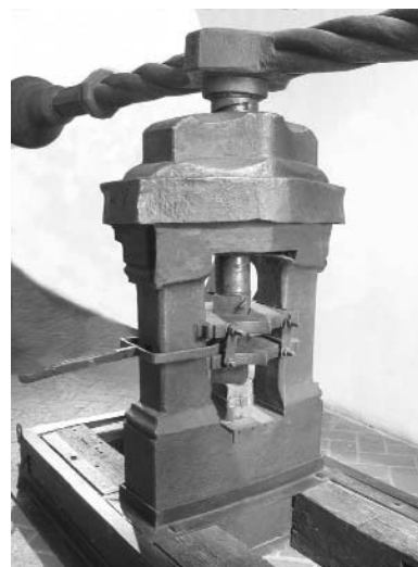
Figura 4. Imágenes de ingenios prensa volante, en Glenn Murray “El Real Ingenio de la Moneda, la fábrica industrial más antigua, avanzada y completa que se conserva Patrimonio de la Humanidad”. Cámara Oficial de Comercio e Industria de Segovia.
