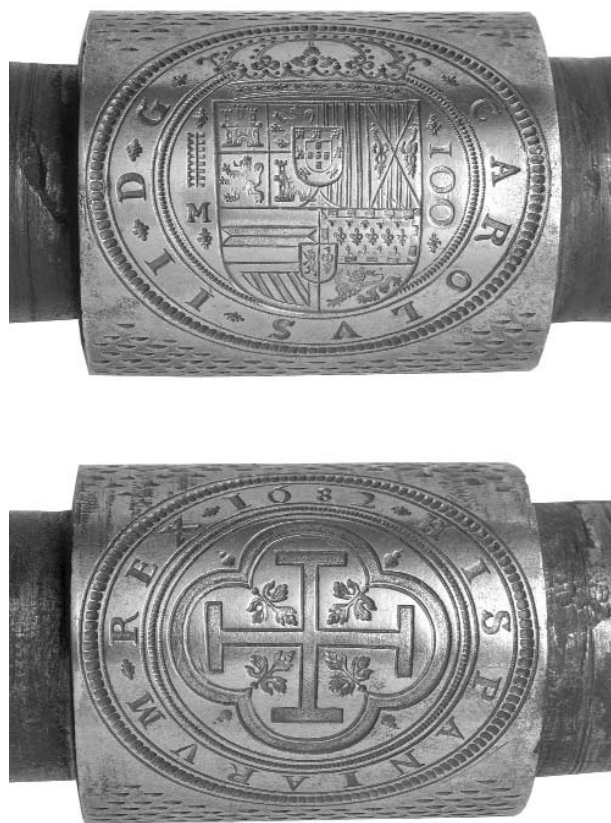
Figura 6. Imágenes de ingenios de acuñación a rodillo, en Glenn Murray "El Real Ingenio de la Moneda, la fábrica industrial más antigua, avanzada y completa que se conserva - Patrimonio de la Humanidad". Cámara Oficial de Comercio e Industria de Segovia.
