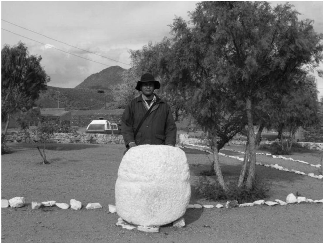
Figura 26. Foto de la voladora o elemento móvil del 'maray' de Boman (1908), aparato que aún se conserva en Cobres.
