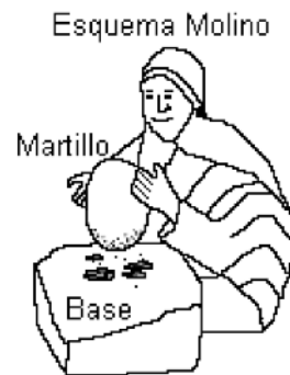
Figura 14. Esquema de un molino quebrantador.
