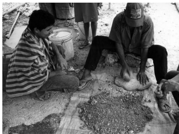
Figura 4.-Molienda en mortero, minería artesanal del oro en las minas de Chinandonga, Nicaragua (Cortesía José Antonio Espi).
