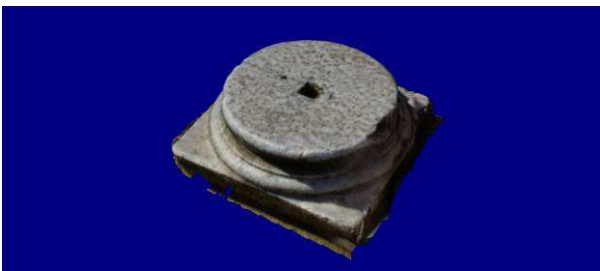
Secuencia de captura dimensional mediante procesos fotogramétricos de escaneado digital.
