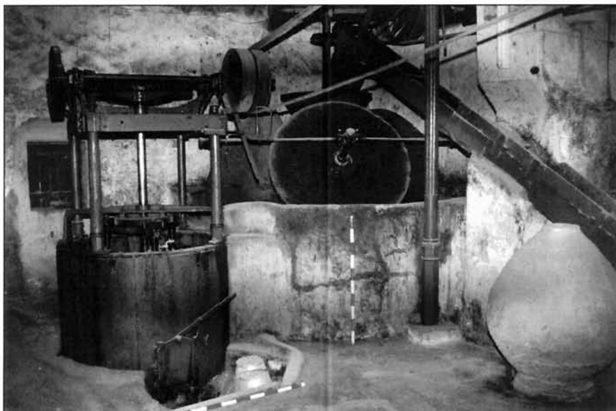
FOTO 5: Vista general de caja transportadora (7), muela (8 y 9), batidora (10) y poceta (11).
