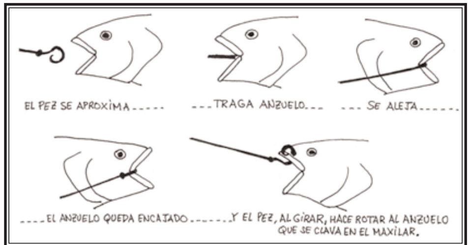
Figura 16. La teoría de cómo actúa el anzuelo rotatorio (Tomado, con modificaciones, de Leach, 2006)
